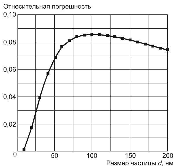
Рисунок Б.1 — Зависимость относительной погрешности результатов вычислений по формулам (2) и (Б.1) от размеров частиц
