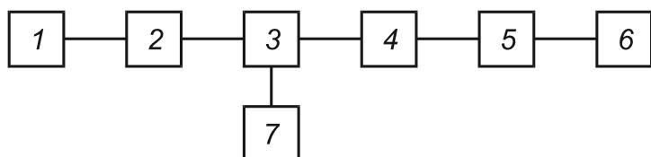
1 — генератор импульсов; 2 — согласующее устройство; 3 — коаксиальный измерительный электрический соединитель из комплекта эталонного вольтметра; 4 — эталонный делитель напряжения; 5 — коаксиальный измерительный электрический соединитель из комплекта поверяемого вольтметра; 6 — поверяемый вольтметр; 7 — эталонный вольтметр
