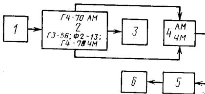
1—генератор типа Г3—56; 2—фазовращатель, входящий в комплект СКЗ—40; 3—фазометр типа Ф2—13; 4—генератор типа Г4—70; 5—поверяемый прибор; 6—анализатор спектра типа С4—34.
