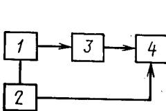
1—генератор сигналов типа Г4—70; 2—генератор сигналов типа Г3—102 или типа Г3—35; 3—поверяемый прибор; 4—фазометр типа Ф2—13.
