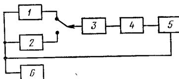
1—генератор, работающий в режиме «ВНЕШНЯЯ ЧМ»; 2—поверяемый генератор; 3—измеритель модуляции; 4—селективный вольтметр; 5—фазометр; 6—генератор модулированного напряжения.
