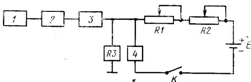
1—проверяемый генератор; 2—измерительный аттенюатор; 3—детекторная головка; 4—фотокомпенсационный монокольтмикроамперметр типа Ф 116/2;  $R1, R2$ —переменные резисторы типа СПИ;  $R3$ —резистор 3 кОм, 0,5 Вт;  $K$ —ключ;  $E$ —источник постоянного тока.
