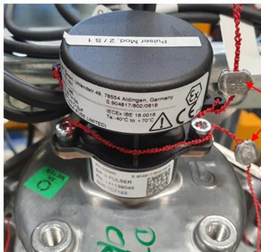
е) Схема пломбировки датчика импульсов SIP-II
