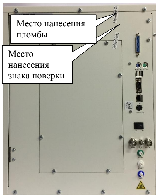
Рисунок 2 – Схема пломбировки от несанкционированного доступа, обозначение места нанесения знака поверки
