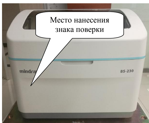
Рисунок 2а – Схема пломбировки от несанкционированного доступа, обозначение места нанесения знака поверки анализатора биохимического автоматического модели BS-230
