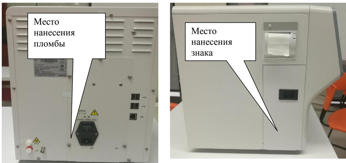
Рисунок 2 а – Схема пломбировки от несанкционированного доступа, обозначение места нанесения знака поверки анализаторов гематологических автоматических моделей BC-20s, BC-30s
