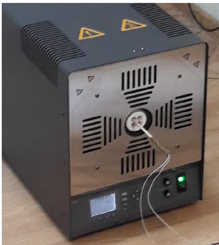
Рисунок 2 – Внешний вид печи в исполнении с изотермическим блоком 9118А-ИТВ Пломбирование печей не предусмотрено их конструкцией.
