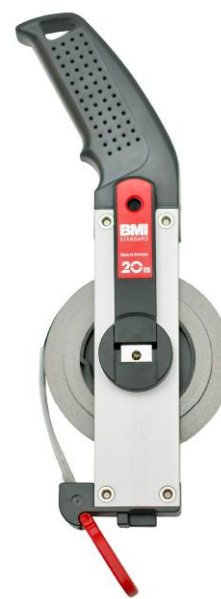
Рисунок 9 – Общий вид рулеток STANDART номинальной длиной 20 м и 30 м
