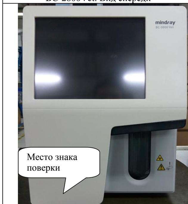
Рисунок 3 - Анализатор гематологический автоматический ветеринарный модели BC-5000Vet. Вид спереди
