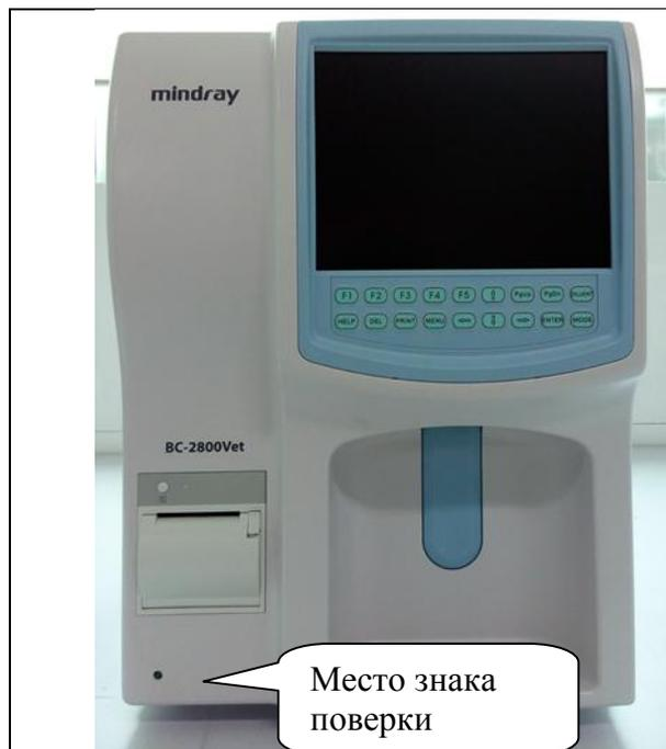
Рисунок 1 - Анализатор гематологический автоматический ветеринарный модели BC-2800Vet. Вид спереди
