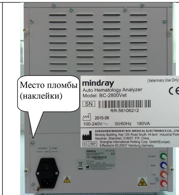
Рисунок 2 - Анализатор гематологический автоматический ветеринарный модели BC-2800Vet. Вид пломбы
