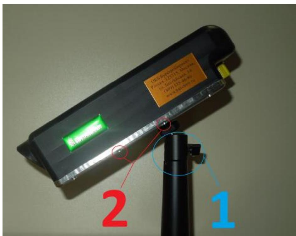
Рис. 2 Датчик состояния поверхности дорожного полотна «ДСПД»
