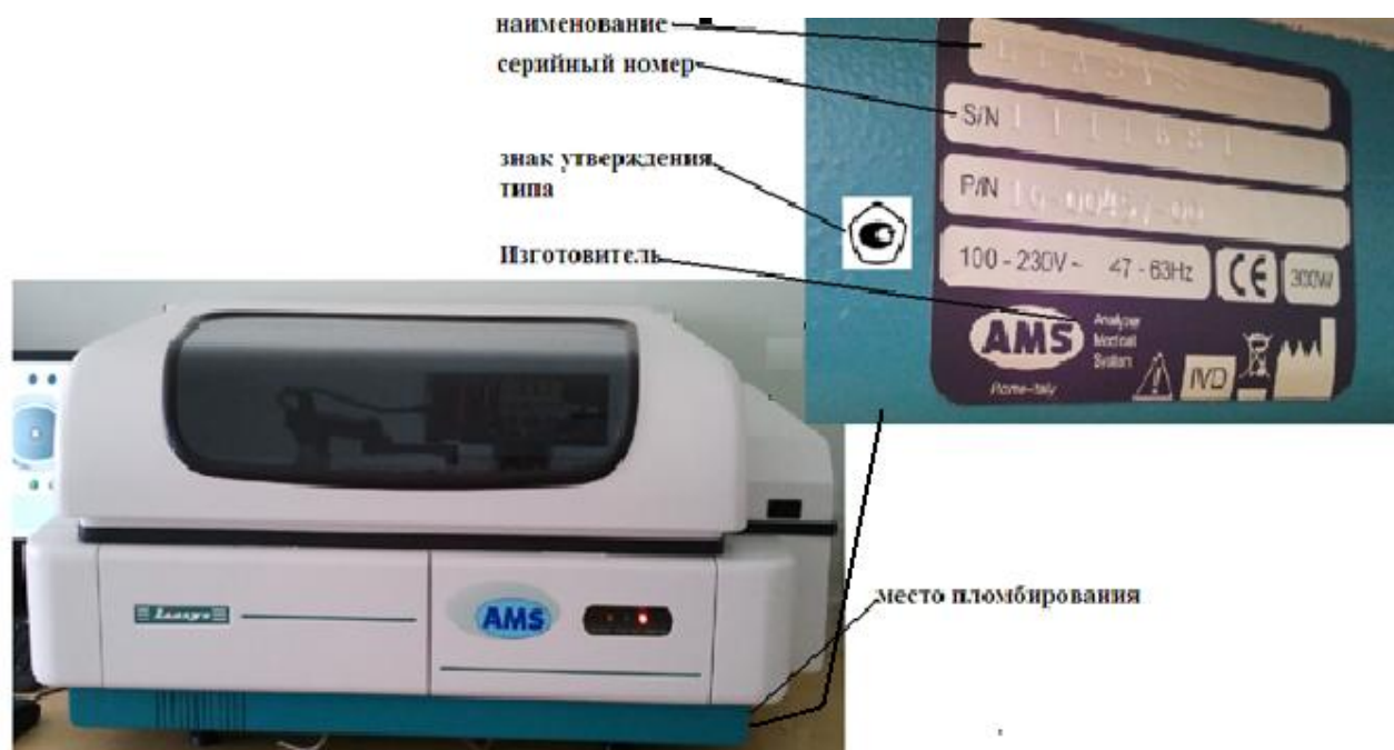
Рисунок 2 – Схема маркировки и пломбировки
