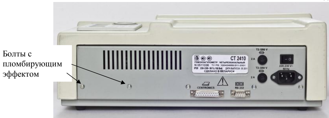
Рисунок 2 – Общая схема маркировки и пломбировки гемостазиметров
