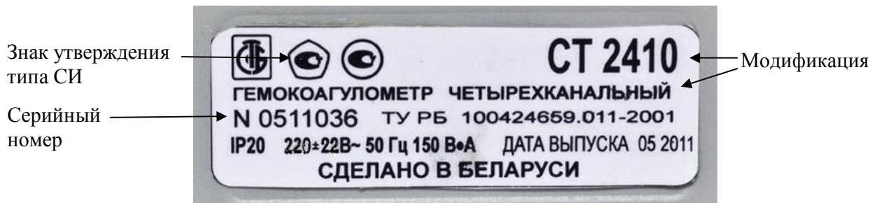
Рисунок 3 – Схема маркировки гемостазиметров
