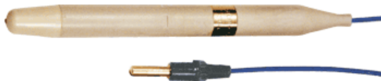
Рисунок 1 – Общий вид электрода сравнения хлорсеребряного насыщенного образцового 2-го разряда ЭСО-01
