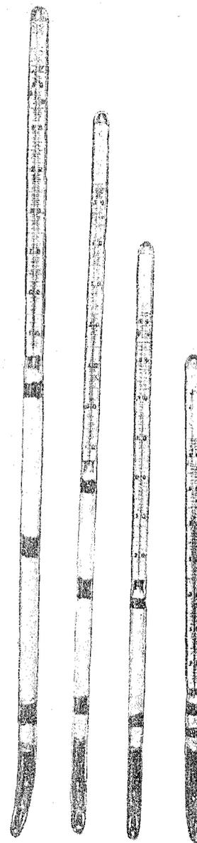
Термометр градуируется при погружении нижней части до перехвата. Термометры типа Савинова
